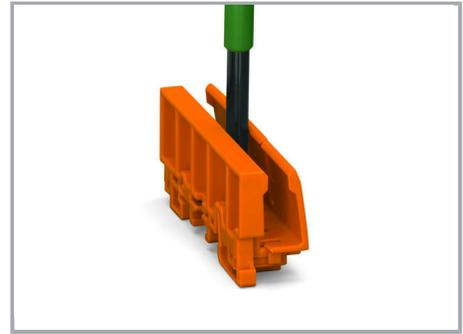
L'adaptateur de fixation est approprié pour les deux largeurs de bornes, déverrouiller l'encliquetage avec l'outil de manipulation (lame 5,5 mm) et porter le collier de serrage à la largeur souhaitée en tournant l'outil.
