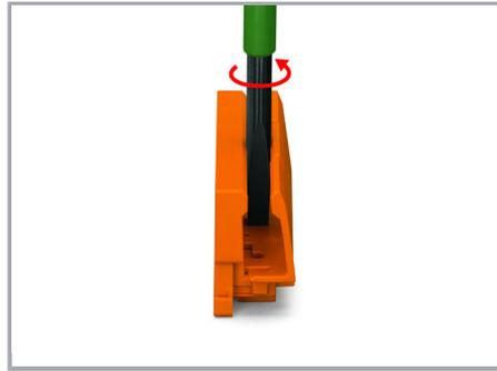
Déverrouiller l'encliquetage avec l'outil de manipulation (lame 5,5 mm) et porter le collier de serrage à la largeur souhaitée en tournant l'outil.
